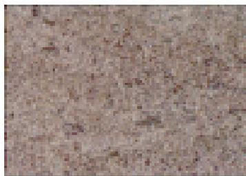
Fig. 12. Grado de preparación superficial Sa 2, de acuerdo con el patrón fotográfico de la norma ISO.
