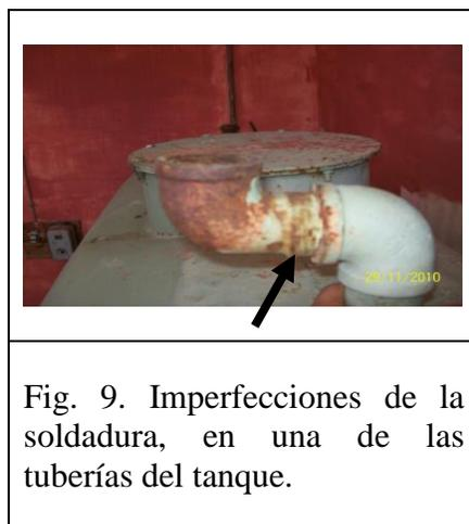
En la Fig. 9 se observa los problemas que ocasionan un mal diseño anticorrosivo por imperfecciones de la soldadura. Se presenta una corrosión localizada, ya que en esas zonas es por donde primero fallan los recubrimientos de pintura por una deficiente preparación superficial, al no estar pareja la superficie.
